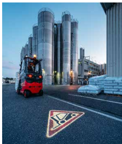
TruckSpot warnt Fußgänger vor rückwärtsfahrenden Gabelstaplern (Linde)
